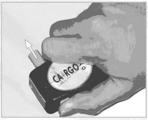
Fijar el adaptador apretando el pestillo hacia la derecha.
